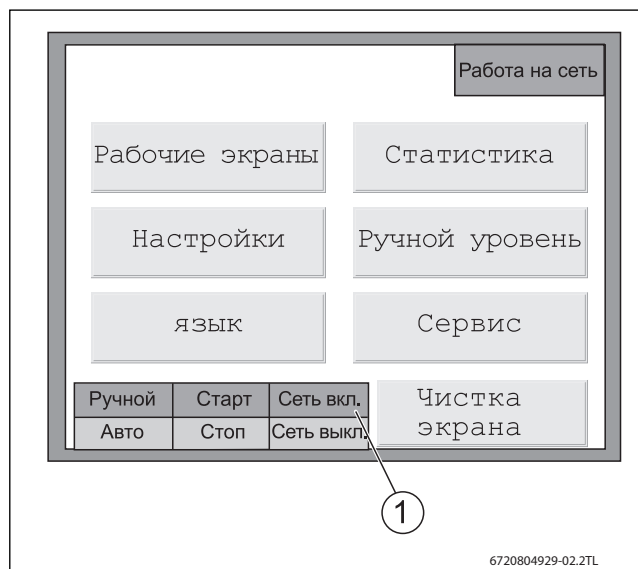
Рис. 30 Включение силового реле генератора
